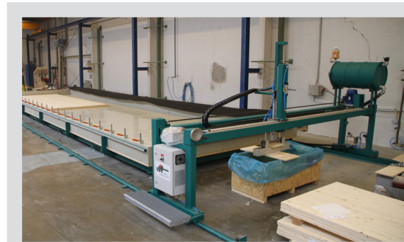
Der eigens zur Vakuumpresse entwickelte Klebstoffauftrag für rasches Auftragen und wenig Unterhalt.
